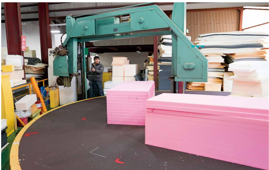
ウレタン材がターンテーブルに置かれ回転して切断される
